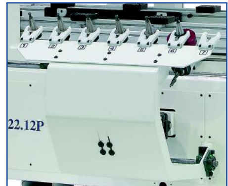
Cambio utensile a 7 posizioni 7 positions automatic tool change
