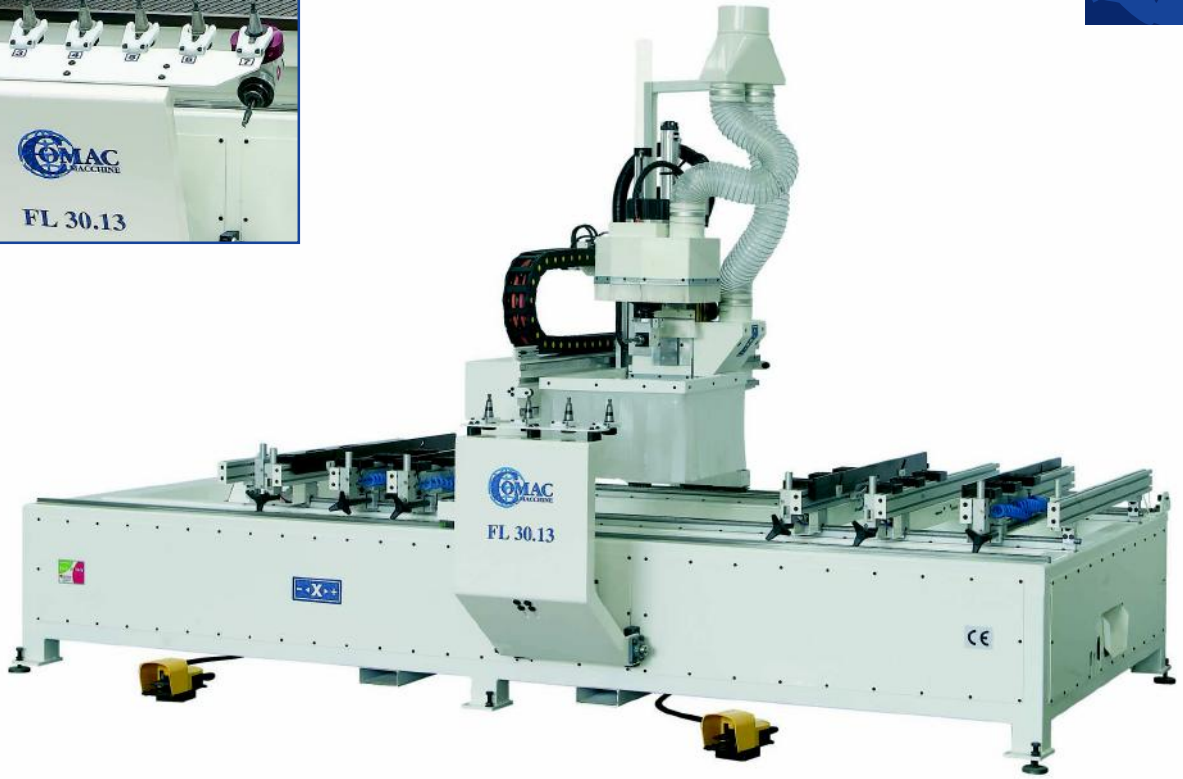
Cambio utensile a 7 posizioni 7 positions automatic tool change
