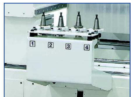
Cambio utensile a 4 posizioni 4 positions automatic tool change
